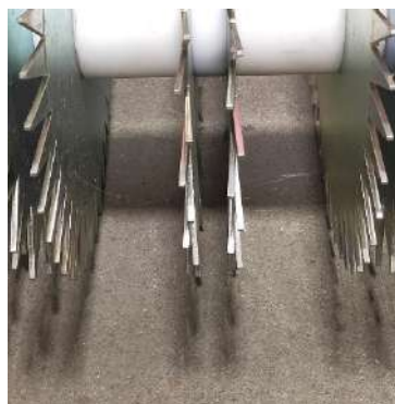
Рисунок 2 Диски Colibri с наклонными зубцами (междурядное расстояние 6-7 см)
